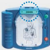
Am Griff der Elektrodenkassette ziehen, um das Gerät einzuschalten. Der Defibrillator gibt Ihnen klare Sprachanweisungen.
